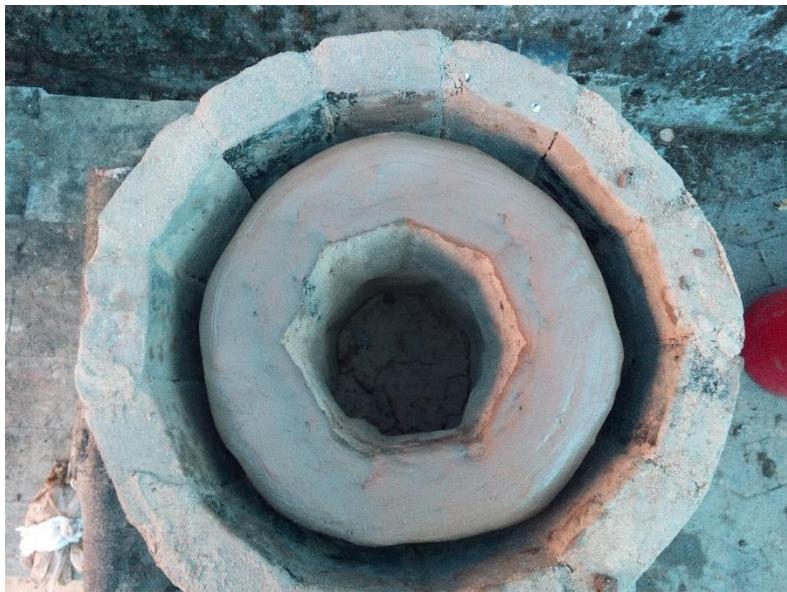
*Abbildung 14: Offene Brennkammer mit Überstromwulst*
