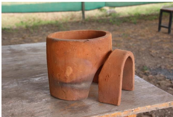
Inlay aus gebranntem Ton (links) und ein Ofen mit Zement-Ummantelung
