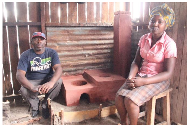
Inlay aus gebranntem Ton (links) und ein Ofen mit Zement-Ummantelung
