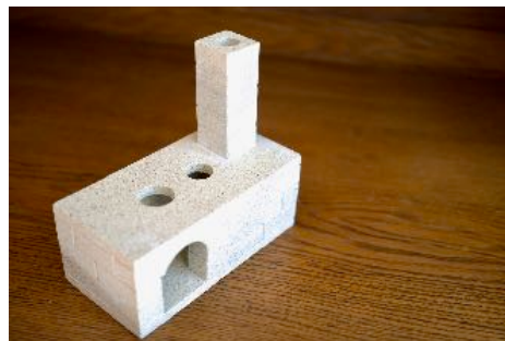
Ofenmodell, zusammgebaut aus 37 Einzelteilen
