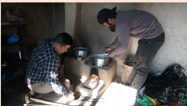
Water Boiling Test in einem Haushalt in Dolakha
