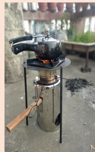
Der Prototyp unseres TLUD-Ofens im Test
