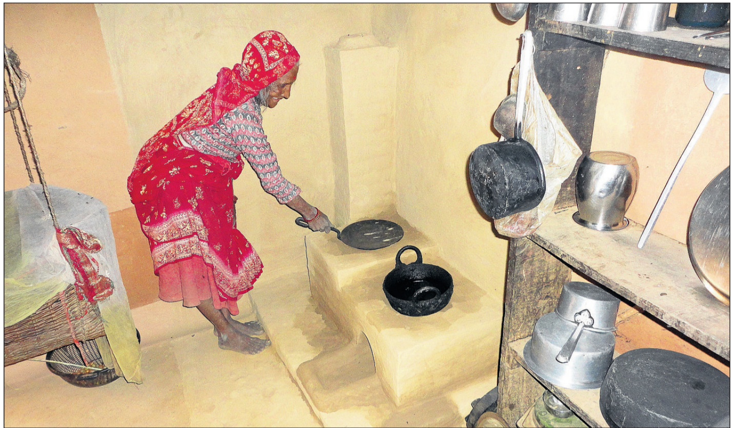
Saubere Sache: Der neue Lehmofen hat einen Abzug nach außen, die Kochtöpfe sind perfekt eingepasst. Jeder Ofen aus dem Klimaschutzprojekt erhält eine Identifikationsnummer (links).
